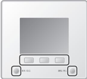
操作ボタンまたは連系/自立、運転/停止ボタンのいずれかを押しすることで、トップ画面を表示できます。
