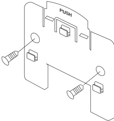
2.本体背面の取り付け穴を壁掛けプレートのフックに差し込み、ロックするまで下に押し下げてください。
