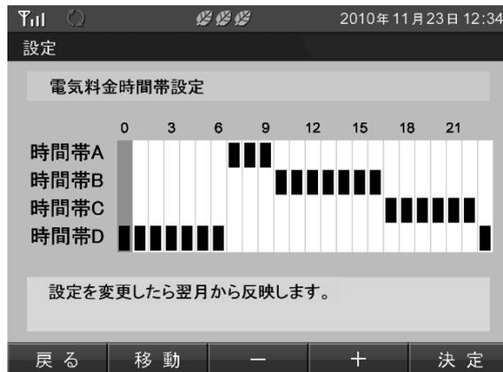
2. **+** / **-** キーで選択している時間の時間帯(時間帯 A～時間帯 D)を変更できます。
