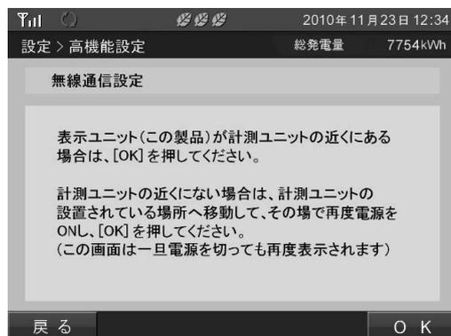
4.計測ユニットの無線設定スイッチを3秒間以上押し、無線設定ランプ(緑)を点灯させてください。無線設定ランプ(緑)の点灯を確認したら10秒以内に **OK** キーを押してください。
